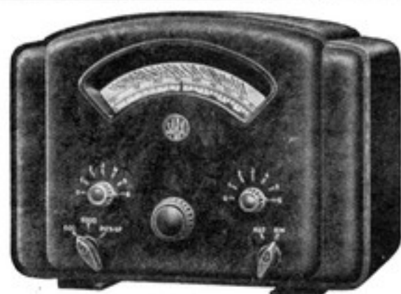
Nr. E 501/1 | HP | 8280 Saba 310 W 3-Röhren-Schirmgitter-Fernempfänger
